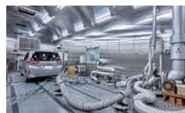
環境実験室とシャシーダイナモ設備上の車両
