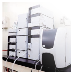
DOMの分子サイズ分布測定 全有機炭素(TOC)検出器を備えたサイズ排除クロマトグラフィシステム
