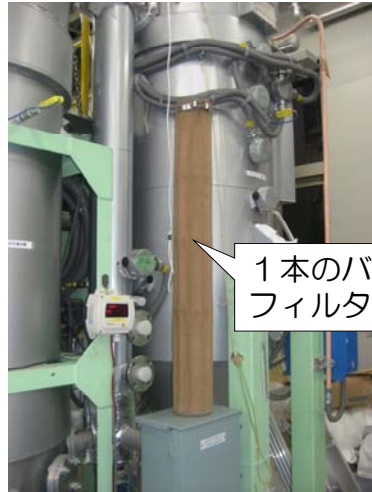
バッグフィルターの構造
