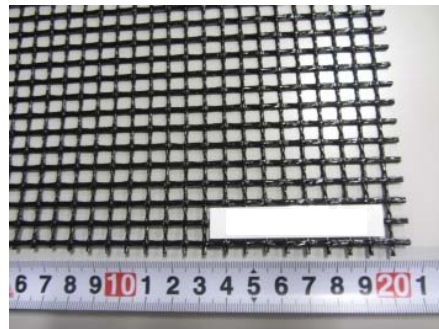
写真 2.2-2 補強材 (ジオグリッド)
