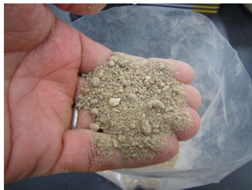
写真 2.2-3 笠間砂 (左：自然含水比 w=10.2\% 、右：気乾 w=1.6\% )
