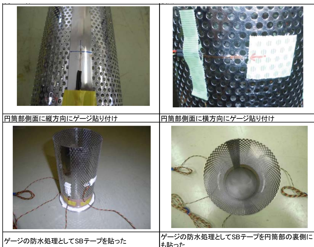
図 1.4-40 本試験で使用した拘束型枠の加工の様子
