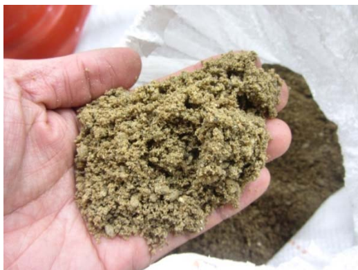
写真 2.2-3 笠間砂 (左：自然含水比 w=10.2\% 、右：気乾 w=1.6\% )
