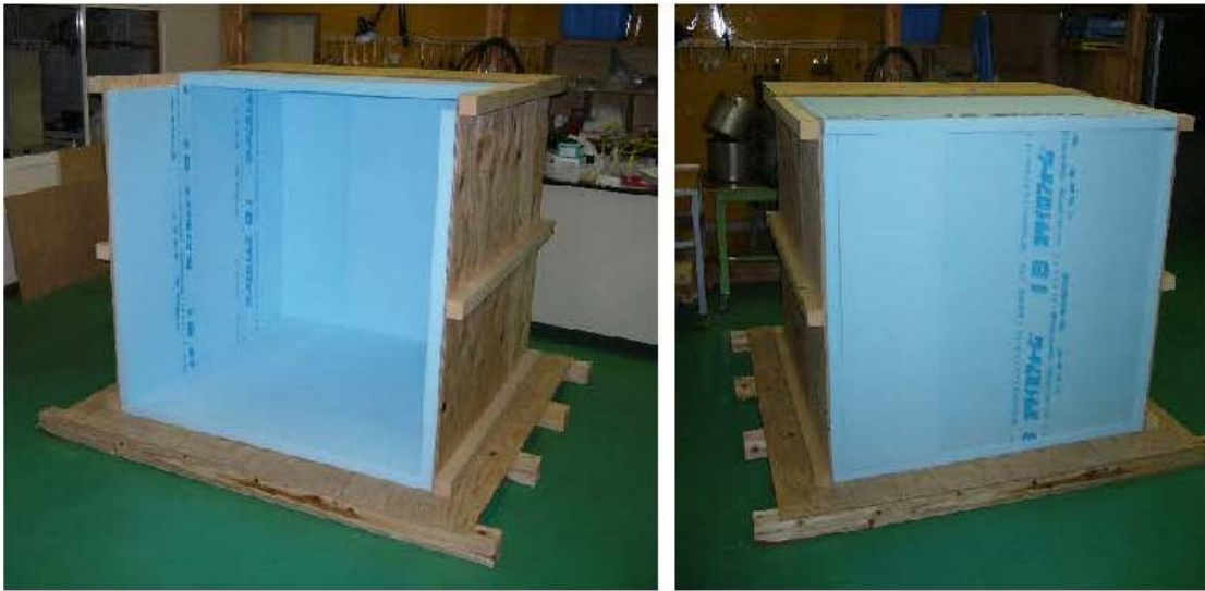
写真 1.5.9 保温材貼り付け状態
