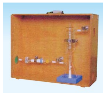
図 3.2-2 凝縮性ダスト採取装置の構成 (木暮, 1997) と実機写真
