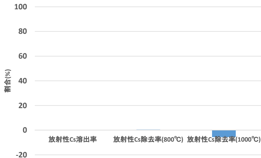
図 2.1-22 放射性 Cs 溶出率と加熱試験結果(除染廃棄物仮設焼却炉)
