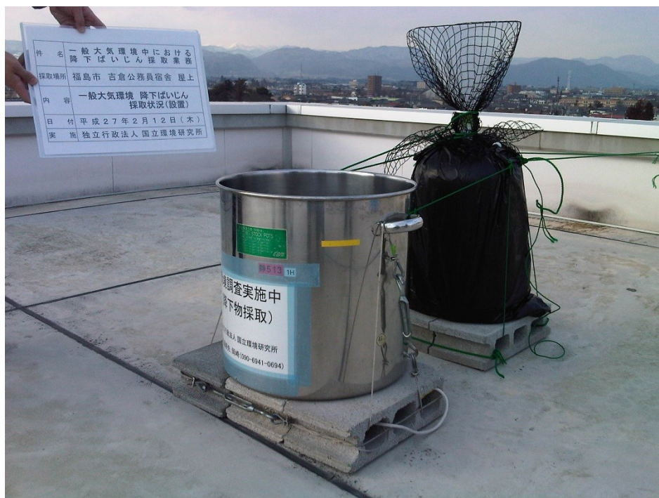
図 3.2-6 大気降水物の採取風景 左手前：ダストジャー法、右奥：デポジットゲージ法
