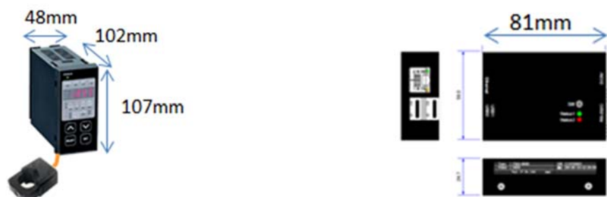
図 1.1-7 電流・電圧計（左）と計測データ集約・一次的保管装置（右）
