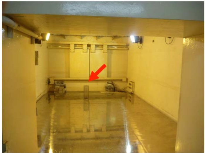
図 1-6 ガンマ線照射施設 (第 1 照射室) 線源の Co-60 が赤矢印の位置にて昇降する
