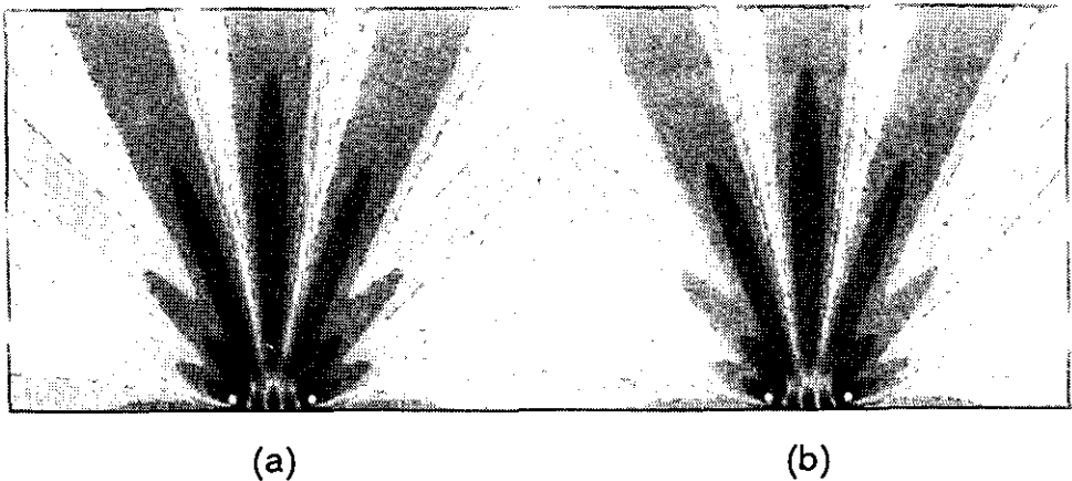
図2 二車線道路が完全反射平面上を走っている場合の音圧レベル分布。 (a)境界要素法, (b)鏡像原理による計算結果.
