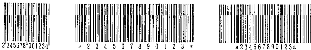
図 2 バーコードのコード体系による同一情報の表示形式の違い 左から、JAN、CODE 39、NW-7 で 234567890123 を表記した。
