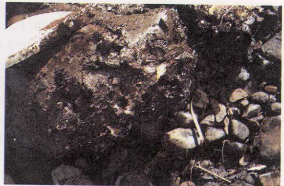
10-4 木ノ浦～シャク崎 採取地点 石の下に堆積した重油層。ここから油塊試料 を採取。
