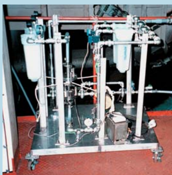
●はじめてフェリー「くろしお」に搭載した手作りの捕集装置(第一世代)
