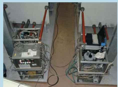
●コンテナ船に搭載したユニット化した捕集システム(第七世代)
