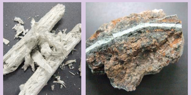
左：繊維状の石綿原石、右：石の中心部を左右に走る白い線の部分が石綿
