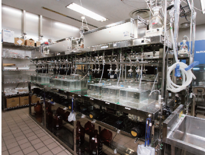
流水式連続曝露装置の外観
