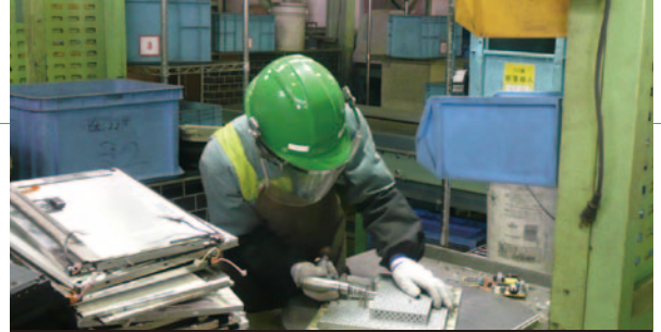
国内の家電リサイクル施設における液晶テレビの分解 (2009年)
