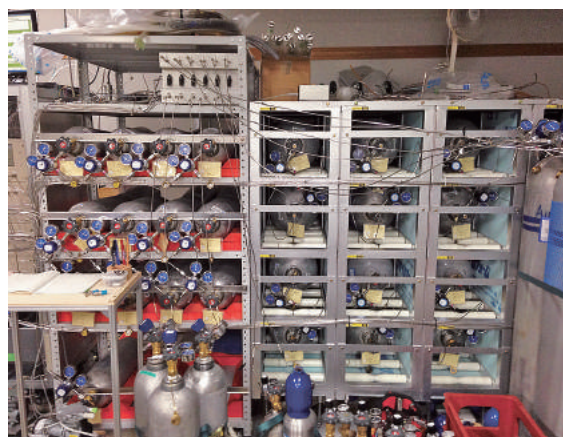
■ 図2 二酸化炭素ガスの1次標準ガスシリーズ(左棚)と2次標準ガス(右棚)
