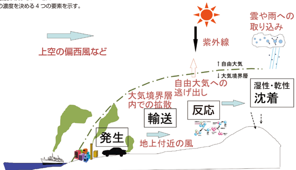
■ 図1 大気汚染物質の濃度が決まるプロセス PM 2.5 等の大気汚染物質の濃度を決定する4つの要素を示す。
