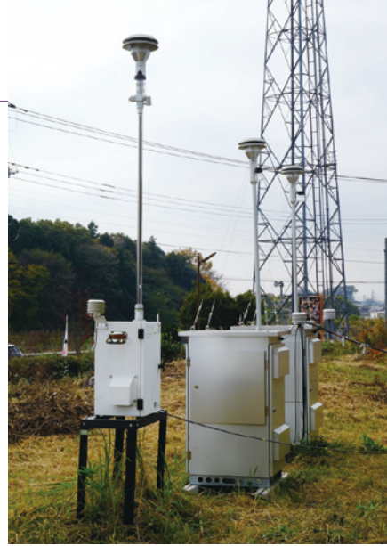
国立環境研究所構内の大気モニター棟横にあるPM 2.5 観測装置
