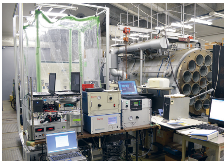
■ 図6 外部テフロンバッグによる二次有機エアロゾルの希釈測定
