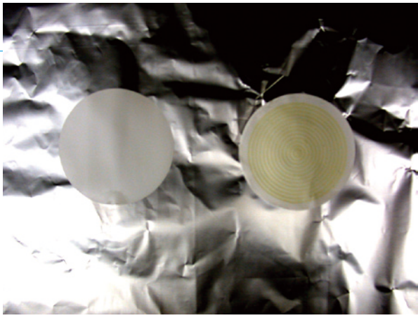
フィルターに採取された二次有機エアロゾル粒子 左は粒子採取前、右は採取後のフィルターです。芳香族炭化水素から生成するエアロゾルは光を吸収することを世界に先駆けて発見し、光吸収成分をニトロフェノール類と同定しました。
