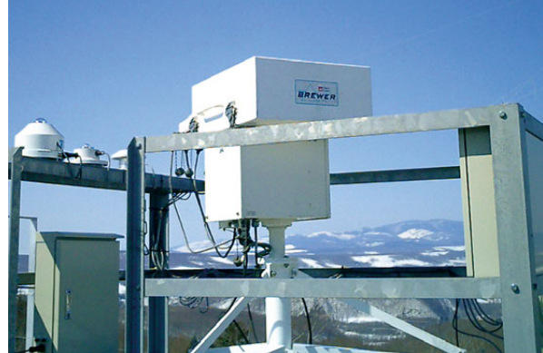
■写真2 ブリューワー分光型紫外線計
