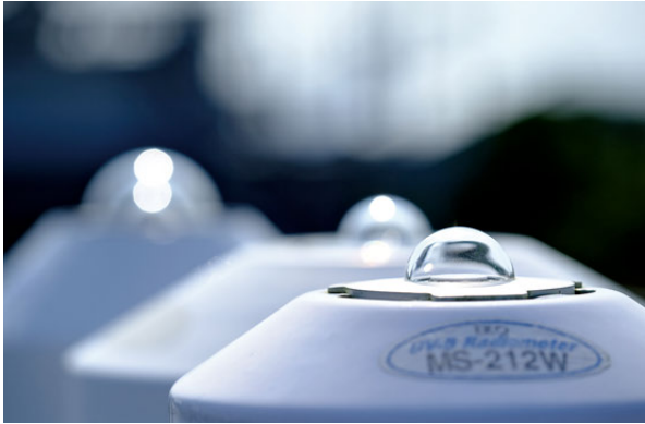
■写真1 B領域紫外線(UV-B)観測装置(MS-212W)
