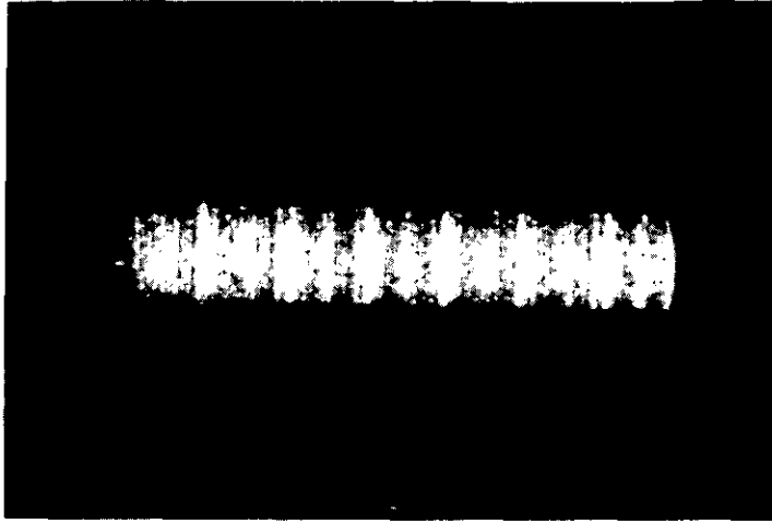
図 5 Perfluoro kerosene ( P F K ) の EI スペクトル ( 蛍光面上での光のイメージ ) Fig. 5 EI spectrum of PFK (optical image on P-20 phosphor)
