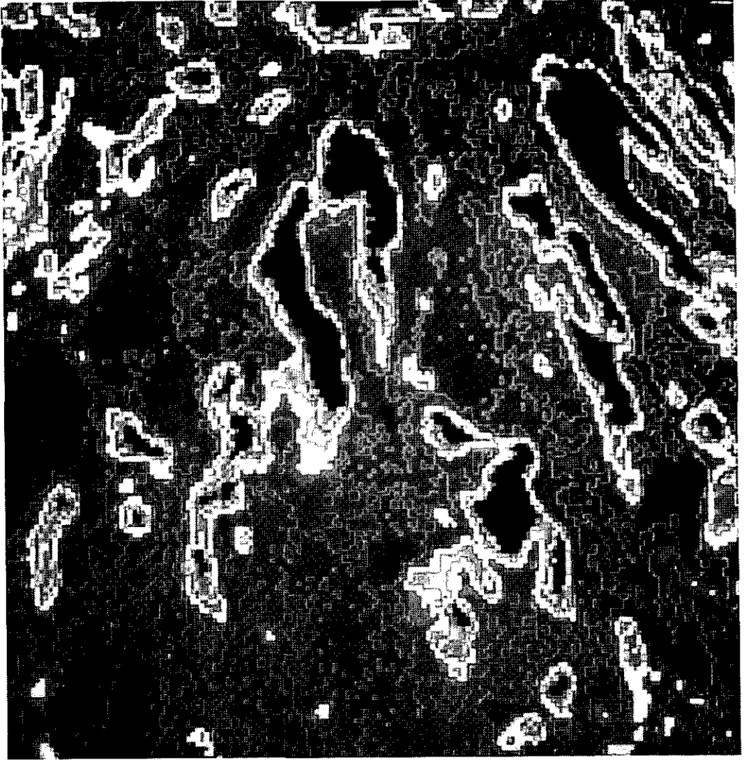
図33 1981年7月31日のRBVのCCTによる鳥海山テストサイトの残雪分布解析 (残雪境界を白で表示した。残雪の厚い部分は濃い黒で示されている。)
