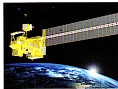
▶ ILAS・ILAS-IIは人口衛星から見た日の出・日没時に、大気を通過してきた可視及び赤外放射を観測し、微量気体の鉛直分布を得る。
