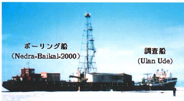
図1 ●堆積物柱状試料の掘削風景 調査船とボーリング船を氷に閉じこめて固定し、掘削しました。
