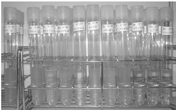
図4．吸光度測定法による結果の例。左端がコントロール。
