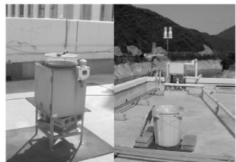
図 2 . 大気降水物採取装置.
