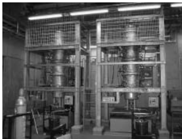
図 4.4.1 ライシメータ（模擬埋立層）全景
