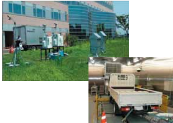
図 2 2007 年夏に実施した二次粒子の生成や挙動を解明するためのフィールド観測 (左上)。排出ガス試験設備を用いた再審ディーゼル車の排出ガス評価実験 (右下)。
