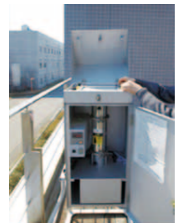
図2 国立環境研究所敷地内に設置されたハイボリュームエアサンプラ
