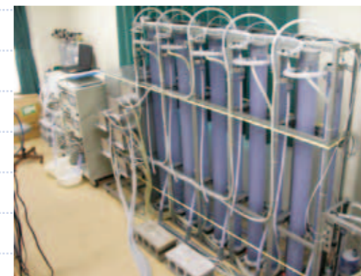
図1 海洋生物飼育実験のために海水二酸化炭素濃度を精密に調整する装置
