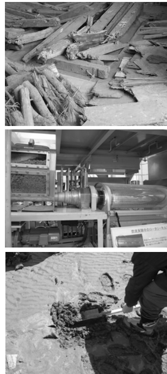
写真：津波を受けた廃木材(上)と燃焼プラントを用いた廃木材燃焼試験のようす(中)、仙台市における津波堆積物の採取のようす(下)
