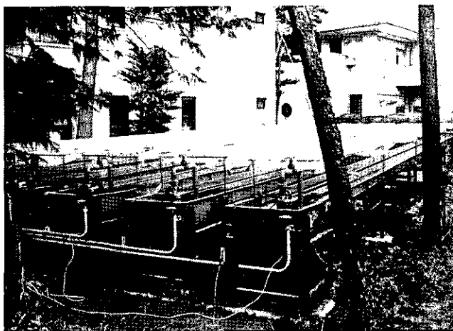
図4 屋外循環式水路 6基、流路長30m、幅0.25m、流速0.15m/s界面活性剤影響実験に用いている。
