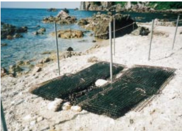
写真1 実証試験現場 ナホトカ号由来の漂着重油に汚染された小石の配置と、散布された栄養剤の拡散具合を観測するための間隙水採取用パイプ
