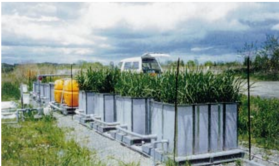
写真 浚渫ヘドロ上にヨシ苗を栽培したシステムによる水質浄化実験の概要
