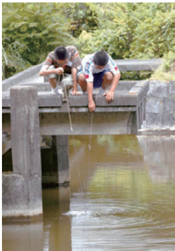
水面下数十cmの深さの水を試料ビンに採取する
