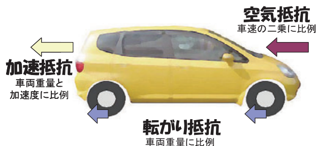
図1 車に作用する3つの力（抵抗）
