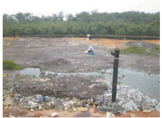
写真5 地表面ガスフラックスの測定風景(手前の黒い筒はガス抜き井戸)
