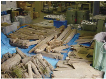
写真1 被災地で採取した廃木材試料 生木、家屋の柱や梁、合板を採取しました。
