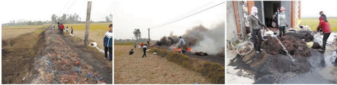
写真2 銅回収を目的としたケーブル等の野焼き 左：水田あぜ道に並べられるケーブル、中央：燃料を投入して燃やされるケーブル、右：銅回収のために燃焼残渣を水洗する様子
