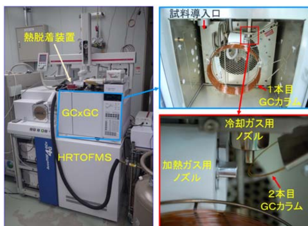
図1 二次元ガスクロマトグラフ/高分解能飛行時間型質量分析計（GCxGC/HRTOFMS）
