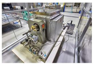
図 3 小型回転式電気炉
