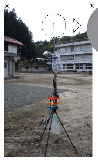
図 5 (a)野外で稼動試験をしているトンボの自動撮 影装置。先端にトンボが止まった場合、(b)の ような形で撮影される
