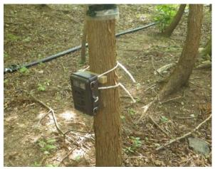
図 1 哺乳類のモニタリングに用いられる 赤外線センサー式の自動撮影カメラ
