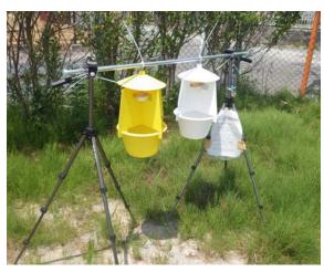
図 4 衝突板トラップと呼ばれる訪花性昆虫用の罠 誘引剤に引き寄せられて飛んできた昆虫がパネ ルにぶつかり、下のバケツに落ちる仕組みにな っている。
