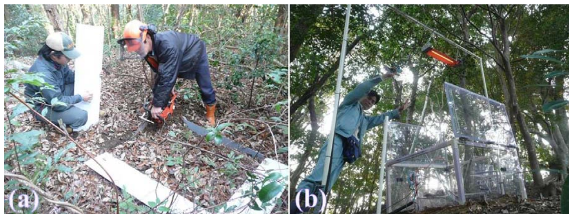
写真1 宮崎のコジイ林における自動開閉チャンバースystem設置時の(a)根切り作業、(b)温暖化区のチャンバーとカーボンヒーター(詳細はLiang et al. 2017 (doi: 10.1038/sdata.2017.26)を参照)。
