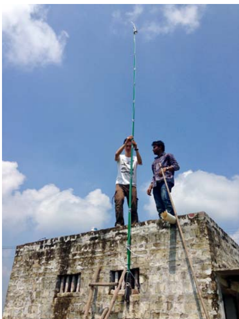
写真2 北インド・ソーニーパットの観測サイト（農家の納屋）に設置した大気採取口
