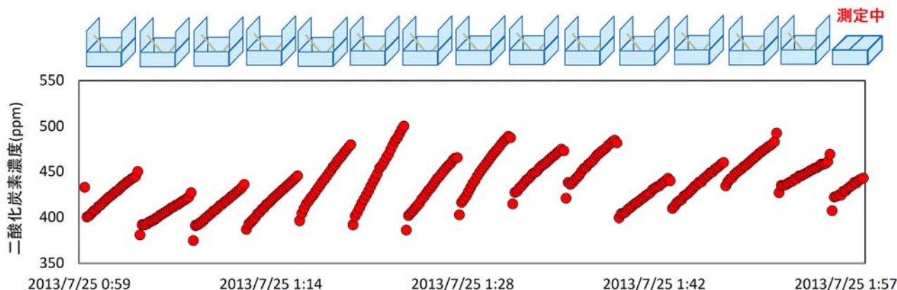
図1 宮崎に設置した15個のチャンバーの模式図と、各チャンバーにおける二酸化炭素濃度の記録。1つの傾きは、1つのチャンバーが4分間閉鎖していた間、そのチャンバー内で変化した二酸化炭素濃度を示す。測定中のチャンバー内(右端)では、徐々に二酸化炭素濃度が上昇している。
