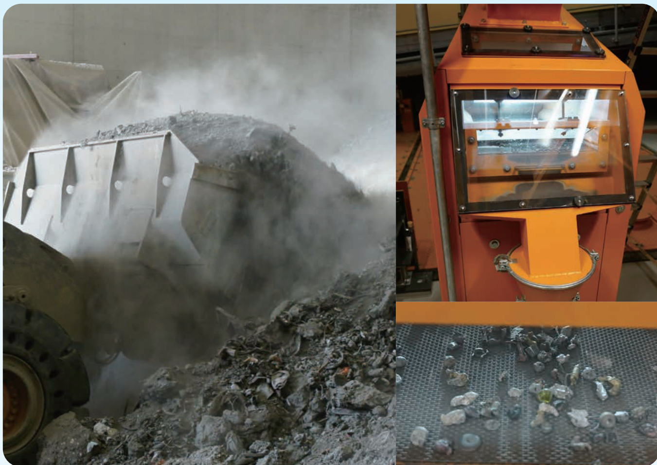
金属回収プロセスに投入される焼却灰／エアテーブル選別機(関連記事は12ページから)
