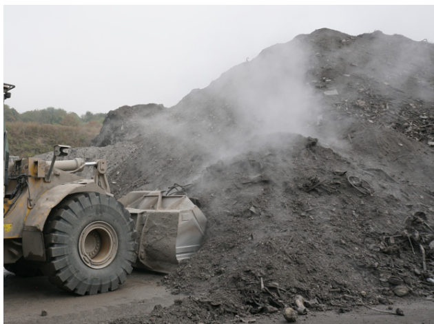
写真1 屋外ヤードに搬入された焼却主灰の様子(ドイツ)
