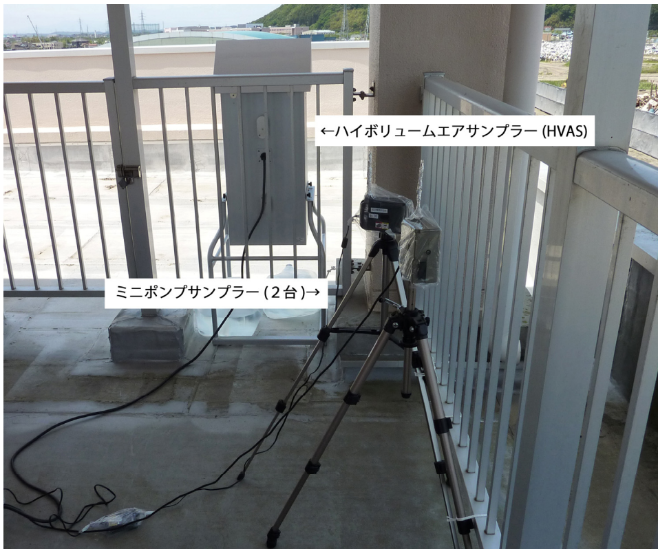
写真3 大気サンプリング風景 (奥: HVAS、手前の2台: ミニポンプサンプラー)
