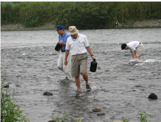
写真1 河川水のサンプリング風景① 浅くて安全ならば、直接採水します
