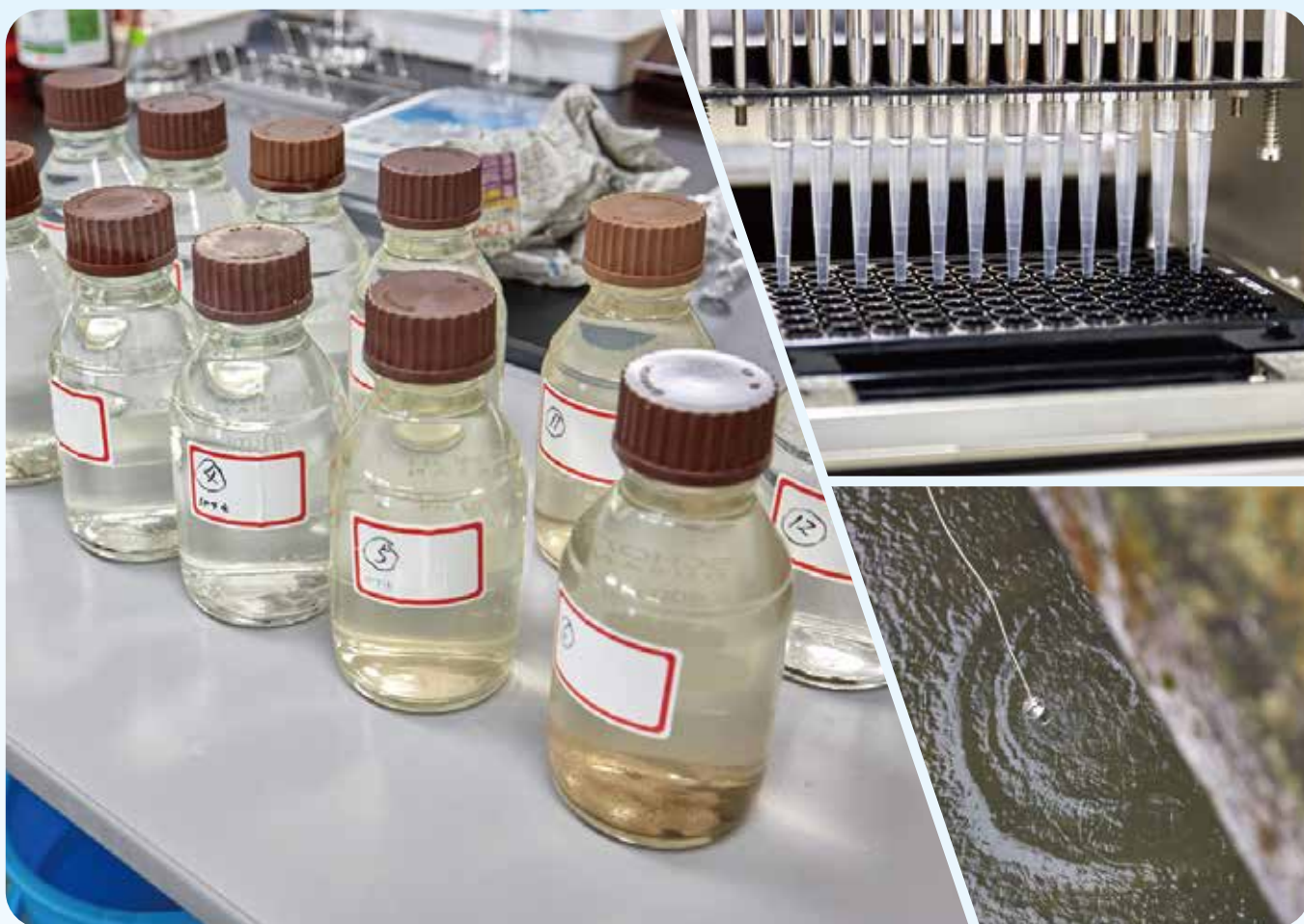
左:環境水試料 右上:バイオアッセイによる毒性試験 右下:河川水のサンプリング(撮影:成田正司)
