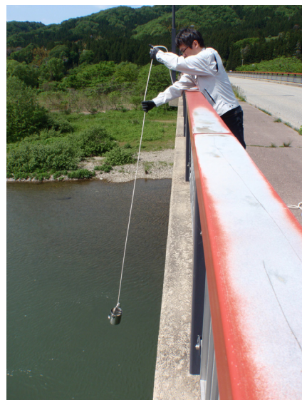
写真2 河川水のサンプリング風景② 高さ30mの橋の上からの採水します
