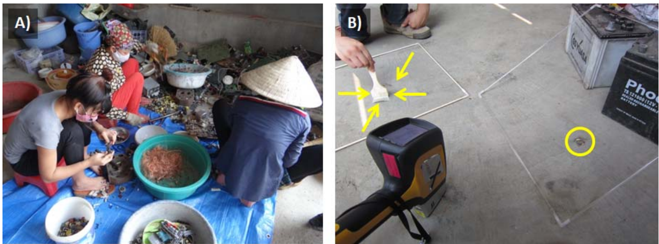
写真2 A) ブルーシートを使って作業者の傍に落ちたダストを集める様子 B) 刷毛を使ってフロアダストを集める様子
