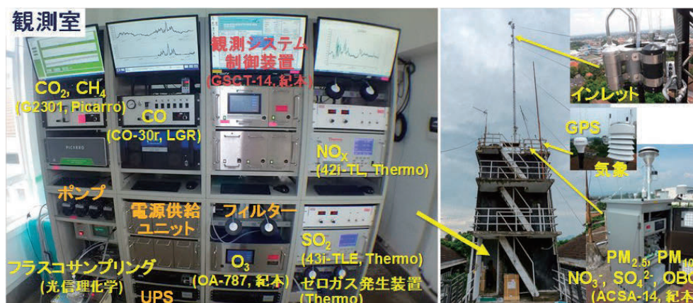
図2 ボゴール(IPB)に設置した温室効果ガス・大気汚染物質の総合観測システム
