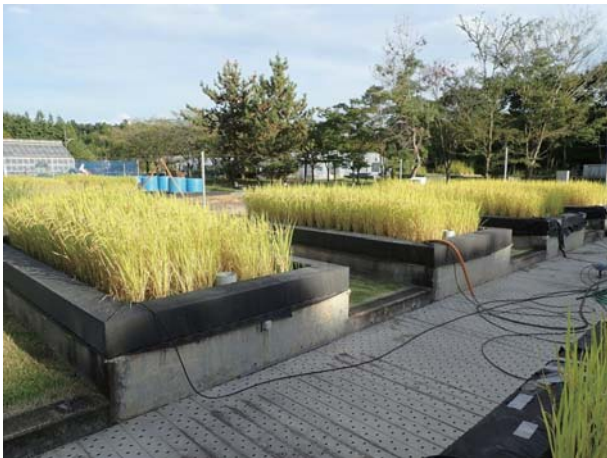
図2 試験用水田。水や土の温度、流出する水の量などを測定できます。育った米は秋に収穫され、収穫祭が催されます。
