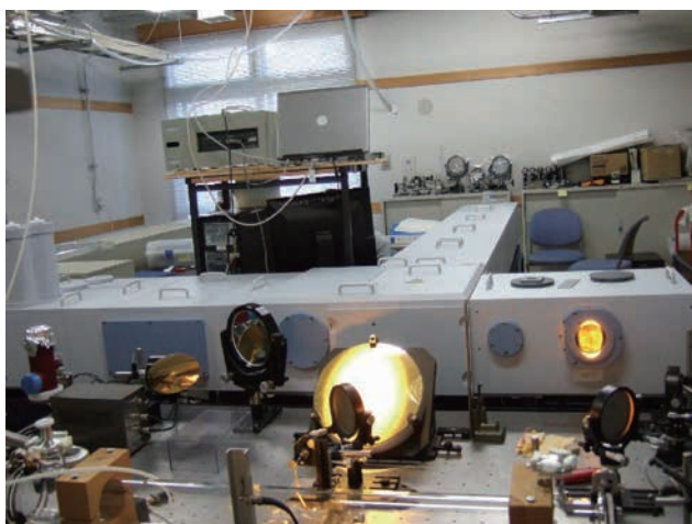
図2 TCCON 観測地点の様子(国環研の地球温暖化研究棟)。左:3階の観測室で太陽光を観測するフーリエ変換分光計。右:太陽光を観測室に導くための太陽追尾装置が設置されたドーム。
