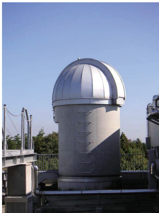
図2 TCCON 観測地点の様子(国環研の地球温暖化研究棟)。左:3階の観測室で太陽光を観測するフーリエ変換分光計。右:太陽光を観測室に導くための太陽追尾装置が設置されたドーム。
