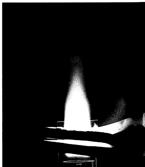
誘導結合プラズマ(ICP)にイットリウムを導入したところ。青く見えている領域では、導入されたイットリウムの99%がイオン化されている。
