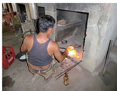
マニラ近郊における小規模リサイクル業者による金製錬プロセス
