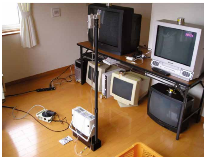
図 67 モデルルームを用いた臭素系難燃剤放散測定例
