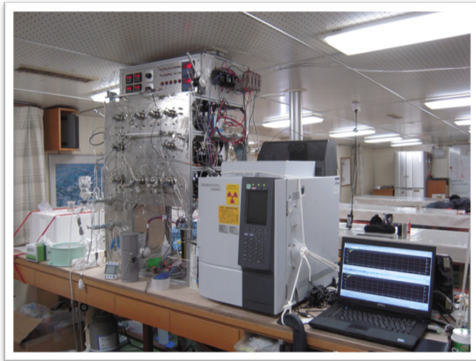
図 18 本研究で開発された溶存ハロゲン化合物の多成分同時定量装置の外観
