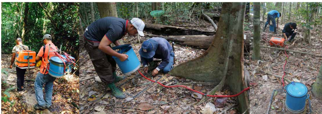
図16 熱帯二次林サイトにおける携帯型自動開閉チャンバーシステムを用いた測定の様子
