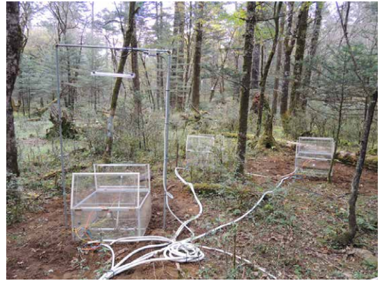
図8 中国亜熱帯亜高山帯天然針広混交林サイトにおける温暖化操作実験の様子
