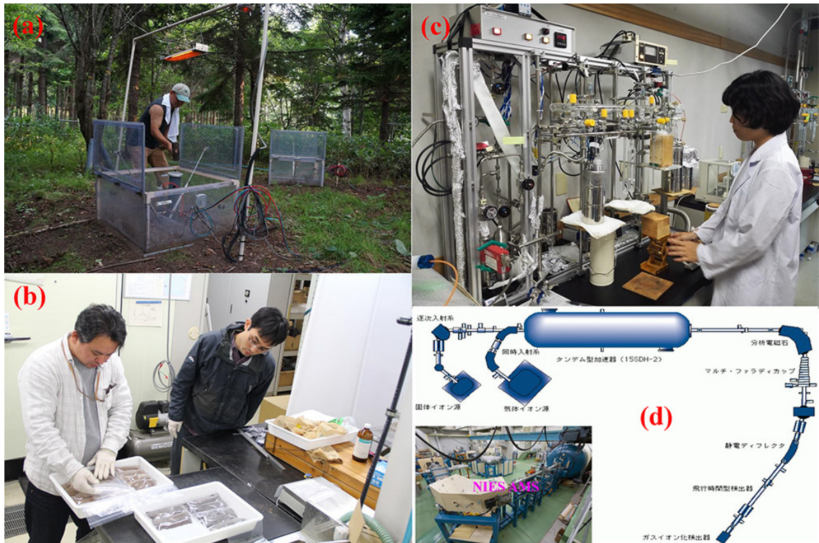
図 67 最北端針広混交林サイトにおける土壌サンプルの採集 (a)、実験室における土壌サンプルの切り出し (b)、土壌サンプル由来の二酸化炭素を濃縮するためのガラスライン (c)、加速器質量分析計 (AMS) による ^{14}\text{C} の測定 (d)
