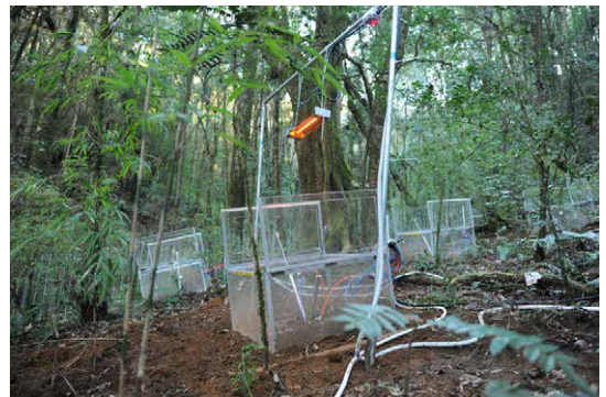
図9 中国亜熱帯亜高山帯天然常緑広葉樹林サイトにおける温暖化操作実験の様子
