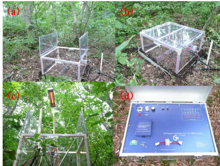
図1 温暖化操作実験サイトに設置されたシステムの概要 (a) 根非除去区、(b) 対照区、(c) 温暖化区、(d) コントロールボックス
