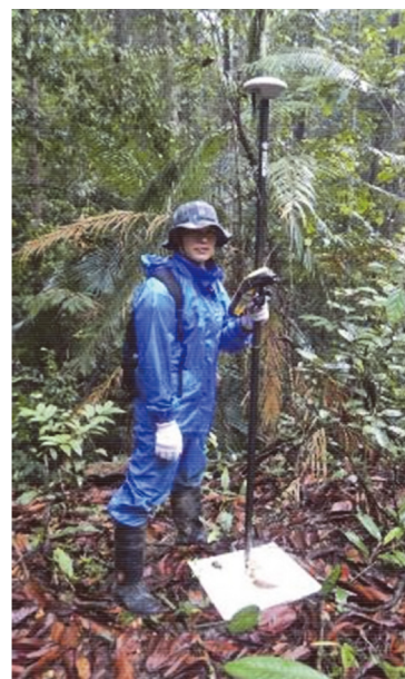
図22 GCP（白板）上での GNSS 測量の様子
