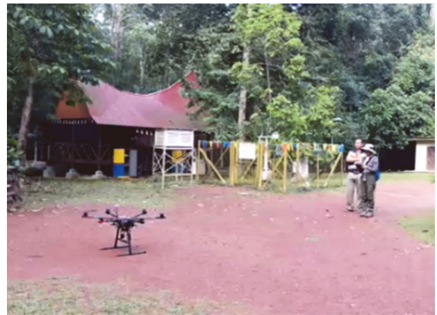
図 24 UAV 運転の様子。発着プラットフォームは、安全のために平坦で十分な広さがあり、見通しが良い場所を選定した。
