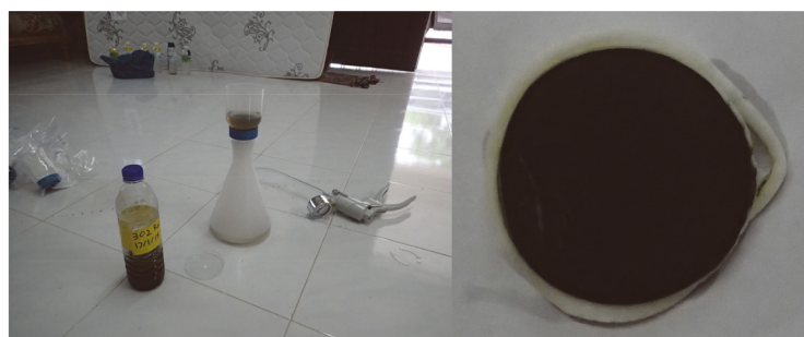
図 36 パン森林保護区における雨水等のろ過の様子。手動式真空ポンプとガラス繊維ろ紙、GF/D (GE ヘルスケア・ジャパン) を使用した
