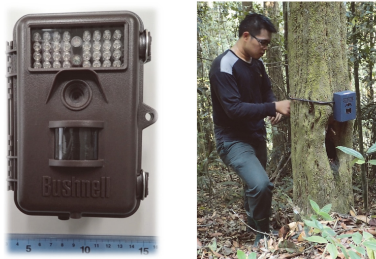
図32 パソ森林保護区内に設置した野外用カメラ(Bushnell TROPHYCAM (Model 119636)) (左)。設置する際には防塵・防水性を高めるために外側を金属製のカバーで覆った(右)。
