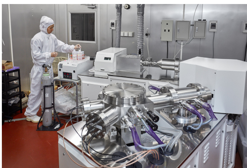
図 14 マルチコレクター ICP-MS を使った Sr 同位体比の測定
