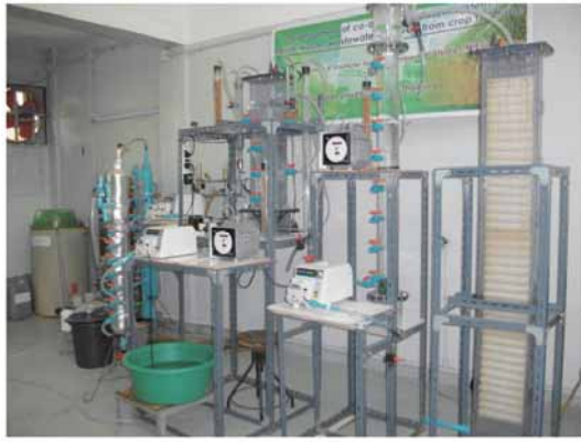
図16 廃水処理試験に用いた処理システムの概要（タイ、コンケン大に設置）
