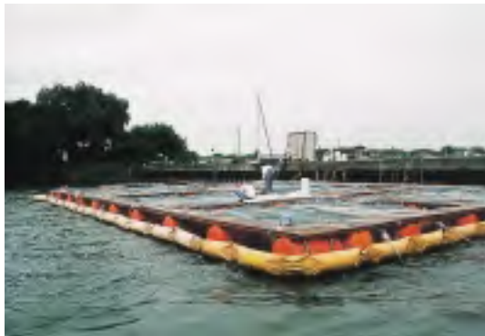
5) 国立環境研究所霞ヶ浦臨湖実験施設のドック横に作った隔離水界6基
